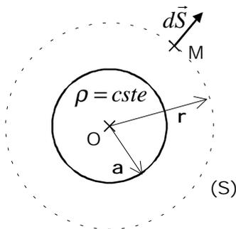
Soit une sphère de rayon a, uniformément chargée en volume; nous allons calculer le champ électrostatique créé par cette sphère, à l'intérieur et à l'extérieur de celle-ci
