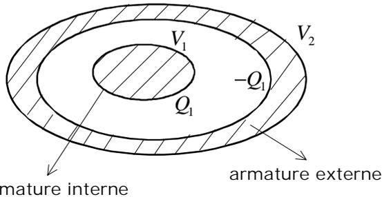
On appelle **condensateur** un système de 2 conducteurs, dont l'un est creux et entoure complètement l'autre.
