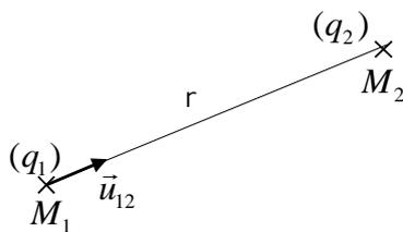
On s'intéresse aux forces électrostatiques apparaissant entre 2 charges électriques **ponctuelles**; la loi de Coulomb s'écrit:
