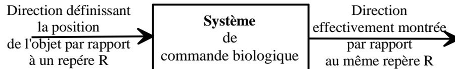
**3- Soit le système de commande constitué par le conducteur et son automobile.** Il est à la fois des constituants fabriqués par l'Homme et des constituants biologiques. Le conducteur cherche à maintenir l'automobile dans une voie appropriée. Il y parvient en comparant sans cesse la direction de la voiture avec celle de la route.
