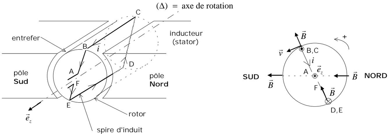
**Rq :** on notera  $L$  la longueur  $BC = DE$  d'une spire, et  $d = BE = CD$  son diamètre ; la vitesse d'un point à la périphérie du rotor sera donc :  $\vec{v} = \frac{d}{2} \omega \vec{e}_\theta$ , où  $\omega$  est la vitesse angulaire du rotor.
