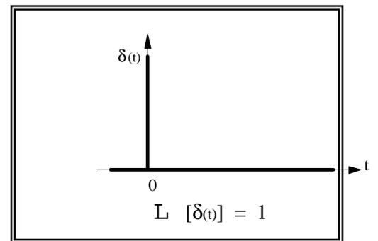
**Remarque :** si pour piloter un système automatique, lors du calcul par le modèle, on démontre qu'il est nécessaire d'envoyer un Dirac, il sera nécessaire de modifier l'automatisme (le schéma bloc). Un Dirac est impossible à réaliser avec précision.
