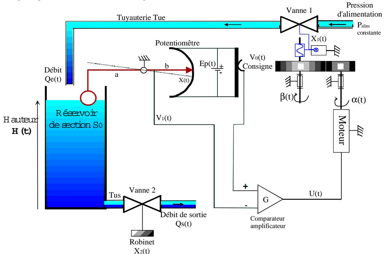
La tuyauterie  $Tu$  alimente le réservoir à travers la vanne  $V1$  de débit volumétrique  $Qe(t)$ . Le robinet associé à cette vanne de section d'ouverture  $X_1(t)$  permet de régler ce débit suivant la position angulaire  $\beta(t)$  de la sortie d'un réducteur de rapport  $1/n$ . Un système vis écrou de pas  $k_1$ , permet de transformer la rotation modélisée par l'angle  $\beta(t)$  en une translation représentée ici par  $X_1(t)$ .
