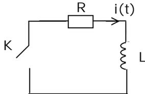
$\left\{ \begin{array}{l} t < 0 : K \text{ ouvert} \\ \quad \quad i = i_0 \\ t > 0 : K \text{ fermé} \end{array} \right.$
