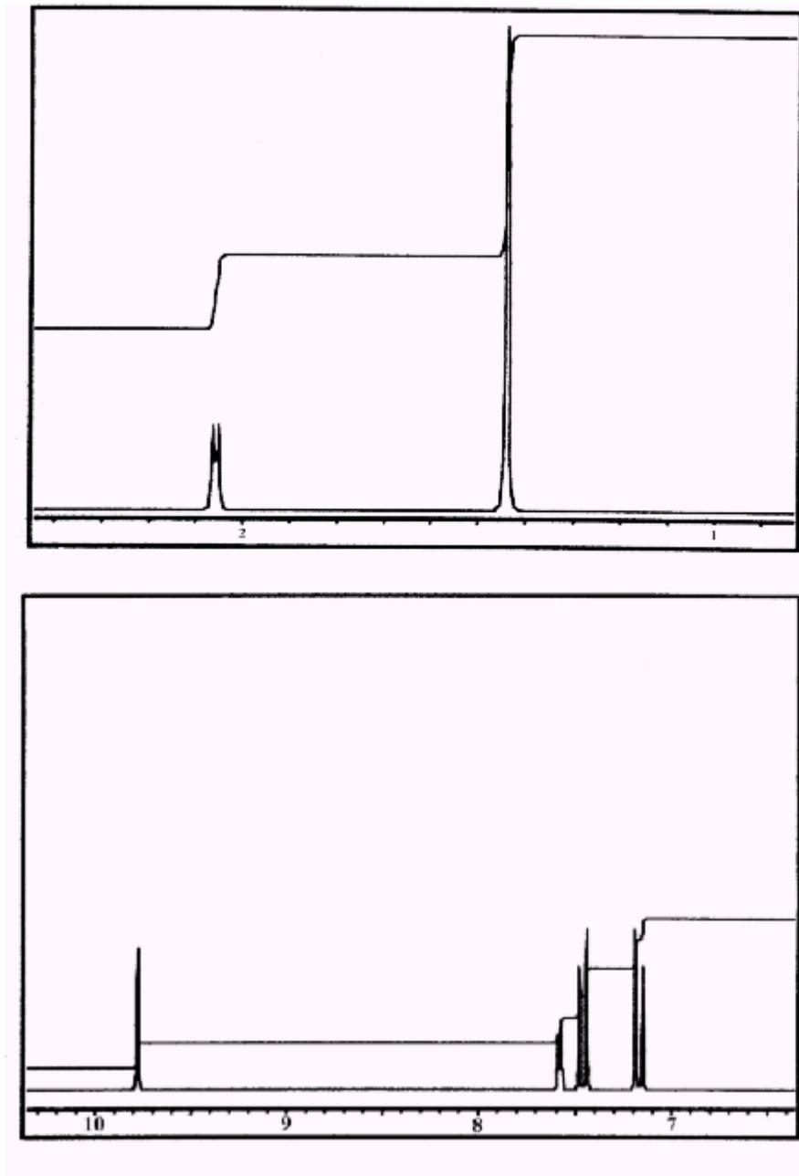
**Figure 1** : signaux RMN du composé **B** ; en abscisse, le déplacement chimique (en ppm), en ordonnée, la courbe d'absorption (pics) et la courbe intégrale transformant les surfaces en hauteur (unités arbitraires).
