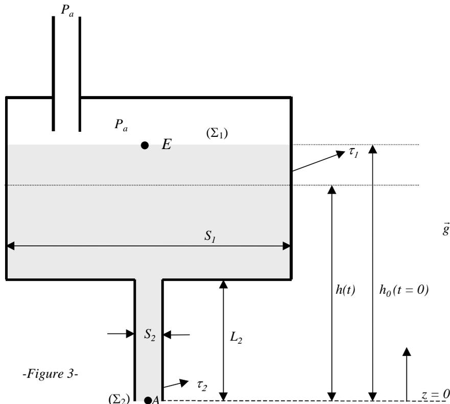
La surface libre du réservoir est maintenant directement reliée à l'atmosphère (voir figure 3). La vanne  $EV_2$  est ouverte et le régime permanent est supposé atteint instantanément. Le volume instantané de fluide contenu dans le réservoir est désigné par  $\tau_1$ , et celui contenu dans le tube de vidange de longueur  $L_2$  par  $\tau_2$ . On supposera de plus que  $S_1 \gg S_2$ .
