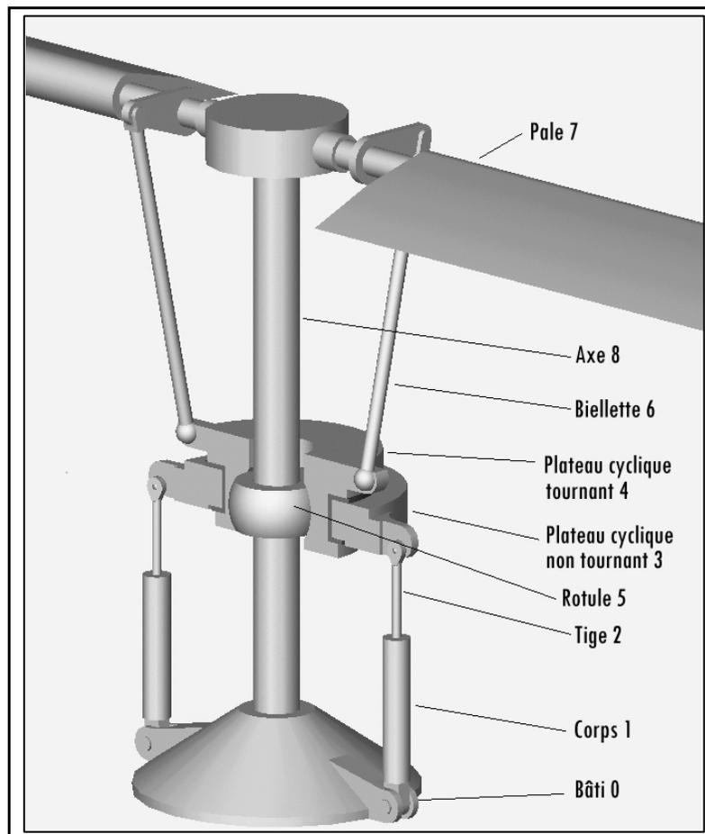
En supprimant le solide 5, c'est-à-dire en l'associant au même sous-ensemble fonctionnel que le rotor 8 et en reprenant le détail des liaisons énoncé dans le sujet (en gras ci-dessous), on obtient le graphe des liaisons (renseigné du nombre de degré de liberté de chaque liaison)
