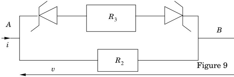
a) Tracer la caractéristique  $v(i)$  du dipôle AB, c'est-à-dire le graphe représentant la tension  $v$  en ordonnée en fonction du courant  $i$  en abscisse. Préciser en fonction de  $R_2$ ,  $R_3$ ,  $V_D$  et  $V_Z$  les différentes pentes et les coordonnées des points particuliers de cette caractéristique.
