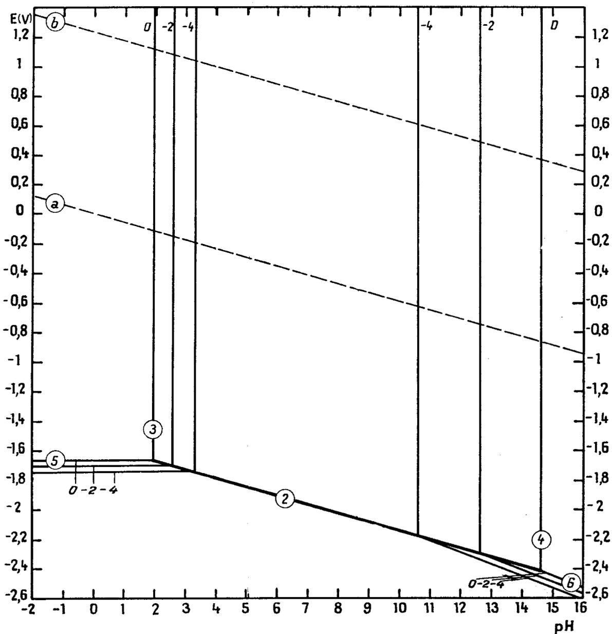
figure 4 : diagramme potentiel - pH de l'aluminium
