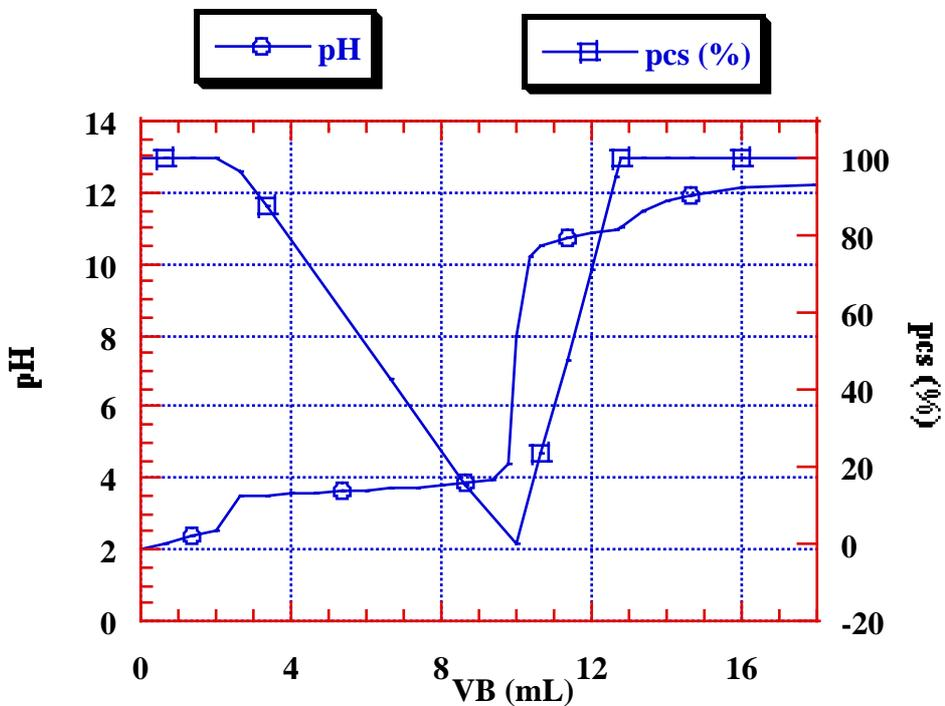
figure 3 : courbes de dosage de la solution A par la solution de soude.
